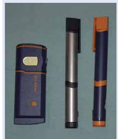
Obrázek 5. Inovo, NovoPen 3, NovoPen 3 Demi jsou určeny k aplikaci inzulinových preparátů firmy NovoNordisk
