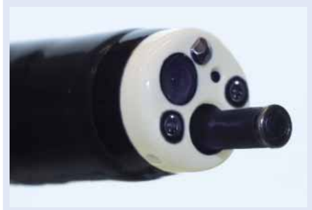
Obrázek 2. Endocytoskopická sonda umístěná v endoskopu
